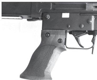
Figure 17: Poignée de pistolet Tactical pour F ass 57
