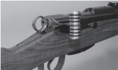
Bild 30: Riegelgriff anatomisch zu Karabiner und Langgewehr
