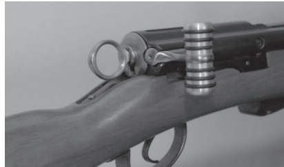
Bild 30: Riegelgriff anatomisch zu Karabiner und Langgewehr
