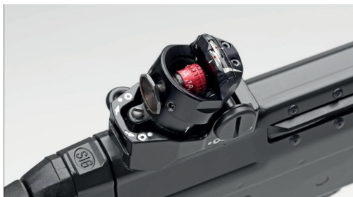
Bild 7: FarbfILTER 12 Farben zu Stgw 90, Modell Grünig & Elmiger
